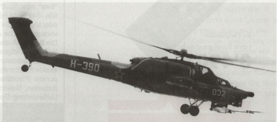
Bild 1. Mi-28 Havoc, Kampfhubschrauber einer neuen Generation. Auf der 30-mm-Kanone ein Pitotrohr zur präzisen Messung der Fluggeschwindigkeit.
