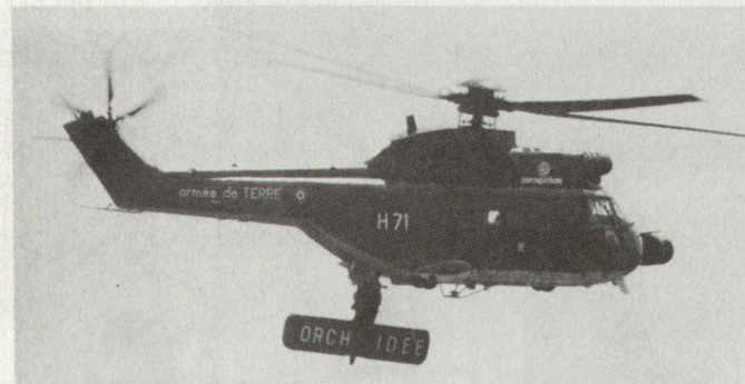
Transporthelikopter AS332 Super Puma mit Gefechtsfeldüberwachungssystem Orchidée . Dieses Aufklärungsmittel wurde im Golfkrieg eingesetzt, obwohl es aus dem französischen Rüstungsprogramm gestrichen wurde.
