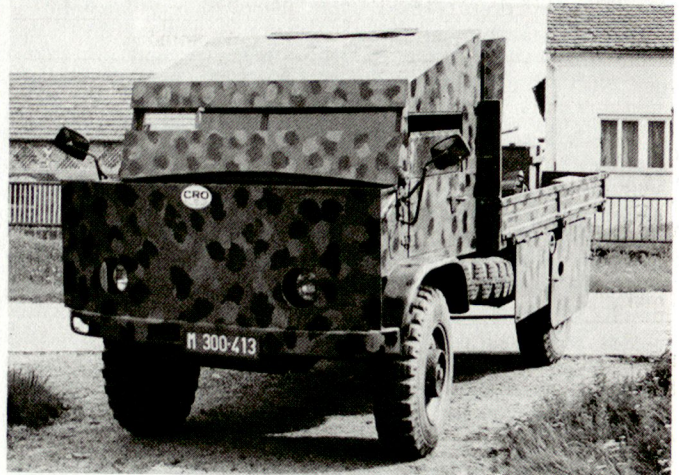
Leicht gepanzerter Geländelastwagen Unimog (1,5t) aus eigener kroatischer Produktion. Auf der Ladebrücke ist in der Regel eine Kanone 20 mm montiert.
