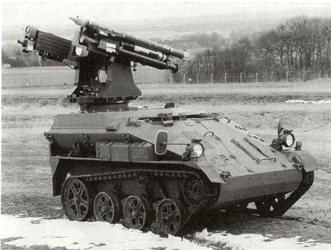
Die deutsche Luftlandebrigade soll künftig über diverse Versionen des Luftlandepanzers «Wiesel» verfügen. Bild: Prototyp eines taktischen Flabsystems mit vielfältiger Lenkwaffenausstattung.
