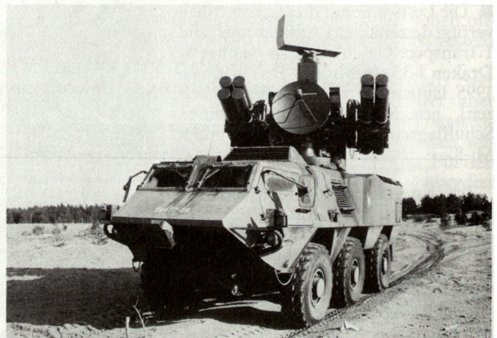
Abb. 5: Das französische Fliegerabwehrwaffensystem «Crotale NG» ist eine der jüngsten Beschaffungen der finnischen Streitkräfte. Die Reichweite beträgt 10 km horizontal und 6 km vertikal.
