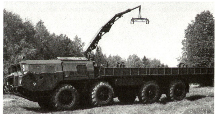
Nachladefahrzeug 9T234-2, ausgerüstet mit einem Kran sowie der Transportkapazität für einen Satz von 12 Raketen.
