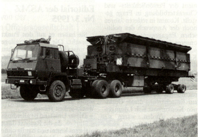
Schwimmbrücke 95. Sattelmotorfahrzeug mit Brückenmodul.
