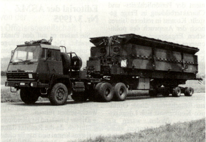
Schwimmbrücke 95. Sattelmotorfahrzeug mit Brückenmodul.
