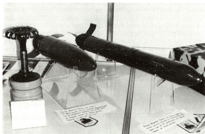
Bei den russischen Truppen werden gelenkte Munitionstypen bei allen neueren Kampffahrzeugen verwendet; links Panzermunition 125 mm REFLEX, rechts 100 mm VISTREL für den Kampfschützenpanzer BMP-3.
