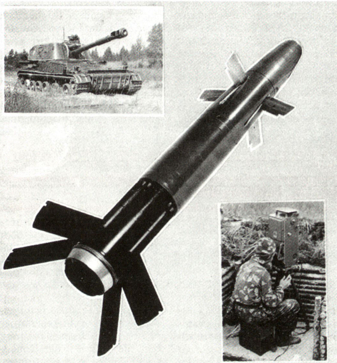
Lasergelenkte Artilleriemunition 152 mm KRASNOPOL, die u. a. mit Panzerhaubitze 2S3M (links oben) verschossen werden kann; zur Zielbeleuchtung dienen diverse Typen von Lasergeräten.
