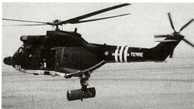
Helikopter Cougar mit Radar für Aufklärungssystem HORIZON.
