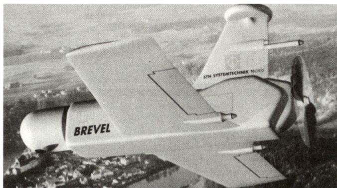
Aufklärungsdrohne BREVEL/KZO bei der Flugerprobung.
