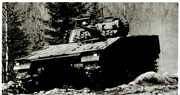
Kampfschützenpanzer CV-9030, ausgerüstet mit Automatenkanone 30 mm.
