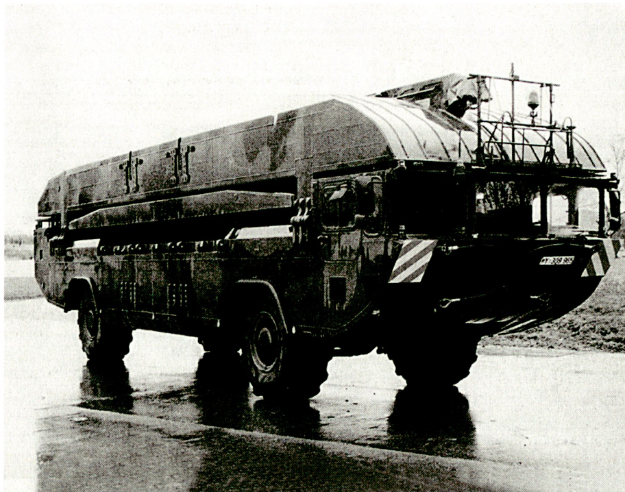
Der neue Stolz der deutschen Pioniertruppen, die Amphibie M3. Dieses System kann als Einzelfahrzeug = Fähre, oder mit mehreren Systemen gekoppelt als Brücke eingesetzt werden. (Bild: Truppenpraxis) ■
