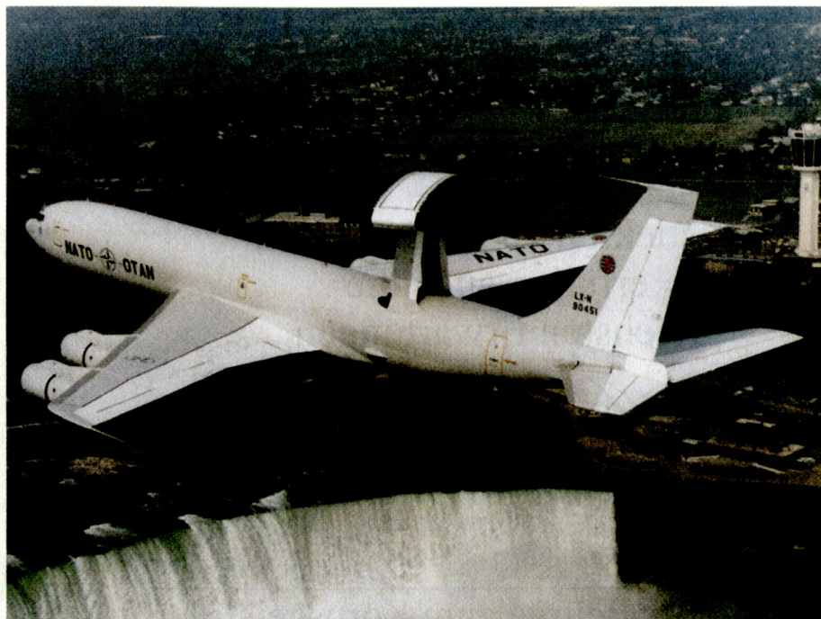
Die Streitkräfte der NATO verfügen total über 56 der sogenannten E-3A-AEW-Flugzeuge, welche auf der Basis des Typs Boeing-707 aufgebaut sind.
