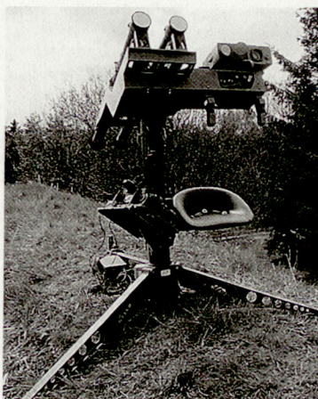
Zwillings-Abschussvorrichtung für die Flab-Lenkaffe «Stinger».
