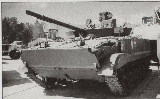
Schutzsystem «Arena 2» auf einem Kampfschützenpanzer BMP-3; erkennbar sind der Kassettenkragen am Turm und die Sensorik zuoberst in der Turmmitte.
