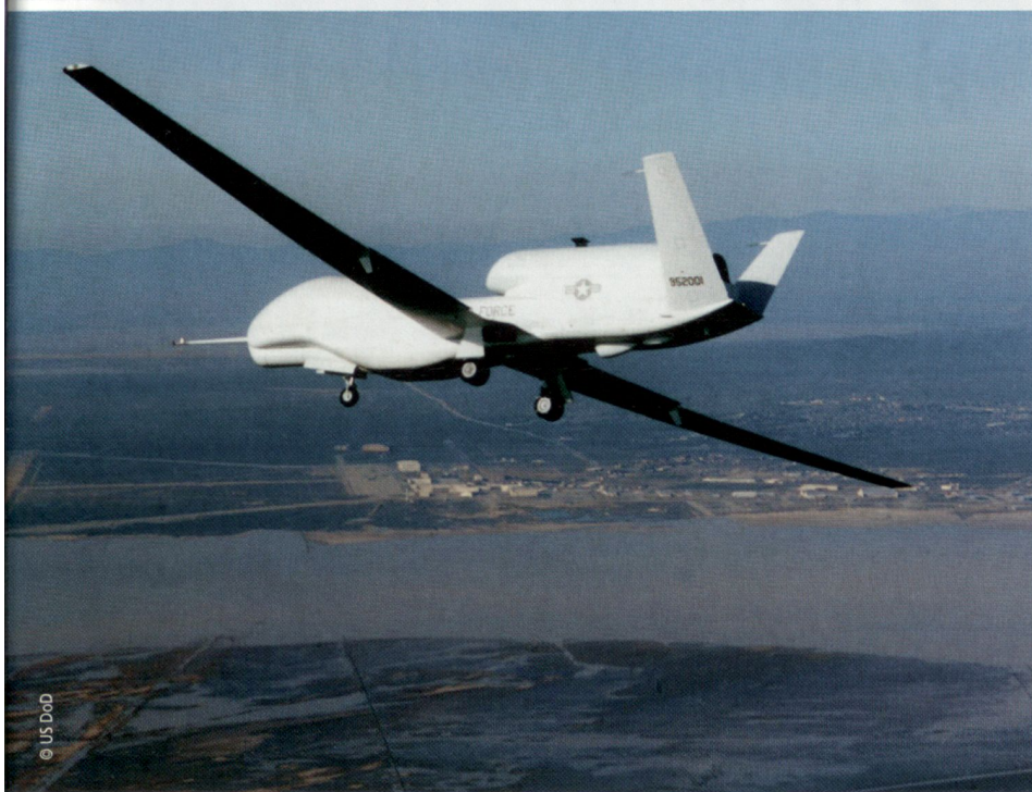
Global Hawk: Hochfliegendes unbemanntes Auf- klärungsflugzeug, das permanente Überwachung sicherstellen kann. (Bild: www.fas.org/ man/index )
