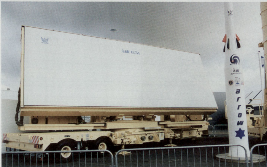
Ein leistungsfähiges Radar ist für ein Raketenabwehrsystem von zentraler Bedeutung. Die Abbildung zeigt das Green Pine Radar des israelischen Systems Arrow II. (Bild: LWND)
