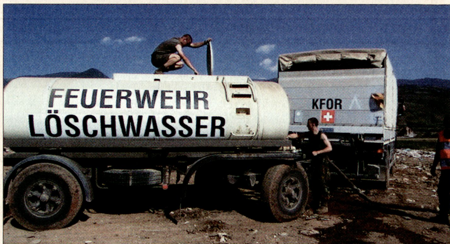
10 000 Liter fassender Löschwasseranhänger der Swisscoy, eines der wichtigsten Arbeitsgeräte beim Deponiegrossbrand Korisha. Vermutlich handelt es sich um einen umgebauten Milchtransporter.
