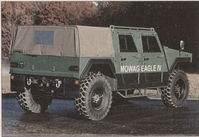
Gut sichtbar der geschützte Mannschaftsraum sowie die ungeschützte Ladebrücke.
