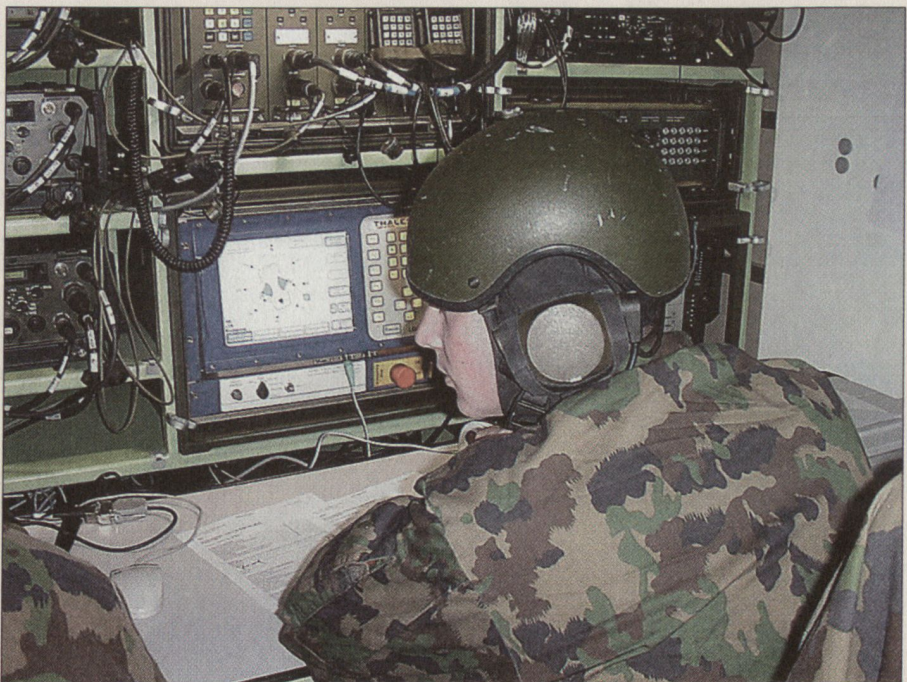
Operateur im RAP-Panzer (Radio Access Point/Funkanschluss): Solche mobile Einheiten stellen die Integration des taktischen Funks ins IMFS plus sicher und erlauben eine bisher nicht bekannte Mobilität.
