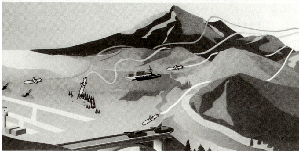
Typische Einsatzmodi von modernen LACM: Konturenangepasster Tiefstflug mit anschliessendem horizontalen Zielüberflug (Zünder auf «Airburst») gegen weiche oder halbhartes Ziele; Pop-up und senkrechter Sturzflug gegen sehr harte, verbunkerte Ziele; Dive-Attack gegen Hafenanlagen, Brücken und andere Infrastrukturziele.
