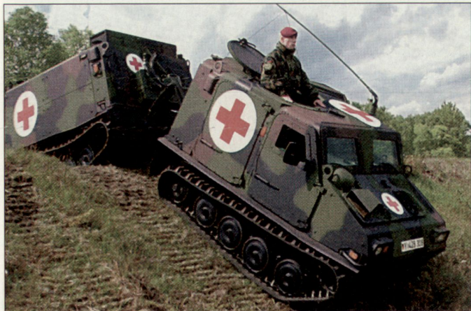
Sanitätsversion des splitter- und minengeschützten Transportfahrzeuges Bv-206S von Hägglund.
