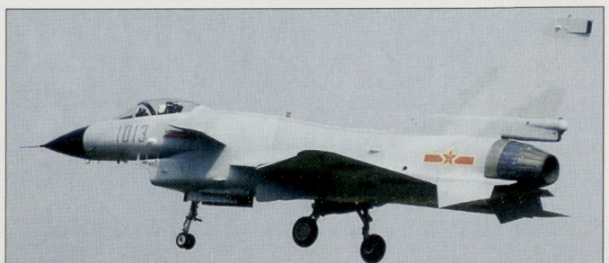
Chinesisches Kampfflugzeug J-10, das mit einem russischen Triebwerk ausgerüstet ist.
