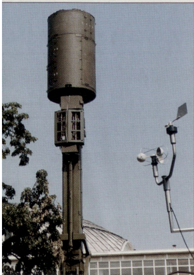
Radaranenne des passiven Ortungssystems «Tamara».
