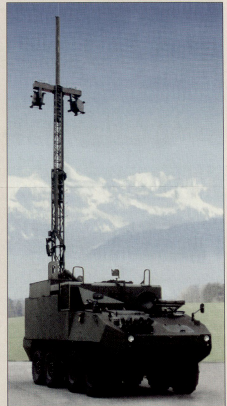
Der RAP Pz mit ausgefahrenem Mast und Richtfunksystem R-905.
