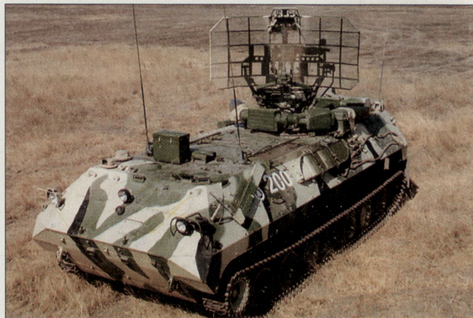
Mobiles Überwachungsradar auf Trägerfahrzeug MT-LB.
