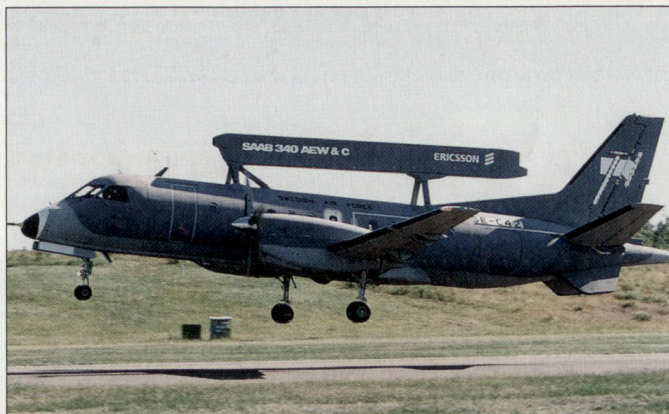
Überwachungsflugzeug Saab S100B «ARGUS», ausgerüstet mit Radarsystem «Erieye».
