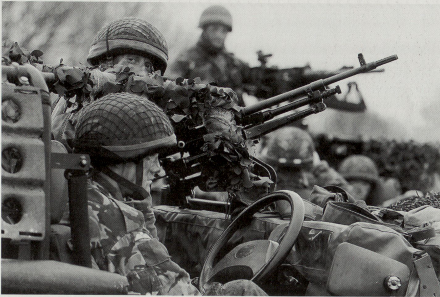
Paratroopers auf Land Rover WMIK ( weapons mounted installation kit ). Das WMIK, bestehend aus dem schweren MG Browning (12,7 mm) sowie einem 7,62-mm-MG. Das Fahrzeug als solches ist luftverlastbar, hoch mobil und damit ideal für Luftlandetruppen.
