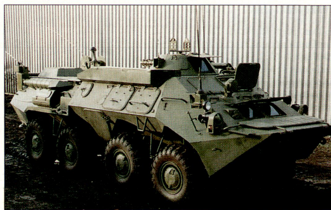
Kommandofahrzeug «Kushetka-B» auf der Basis des Schützenpanzers BTR-80.
