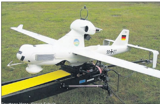
Alle Aufklärungsverbände und -einheiten der Bundeswehr verfügen künftig über unbemannte Luftaufklärungsmittel (Bild: Drohne für die Nahauflklärung «LUNA»).
