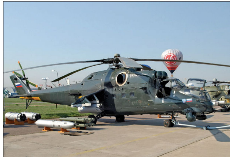
Beim Kampfhelikopter Mi-35 handelt es sich um eine modifizierte Exportversion des Mi-24 «Hind».
