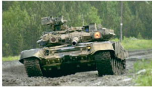
Schutzsystem «Shtora-2» auf Panzer T-90.
