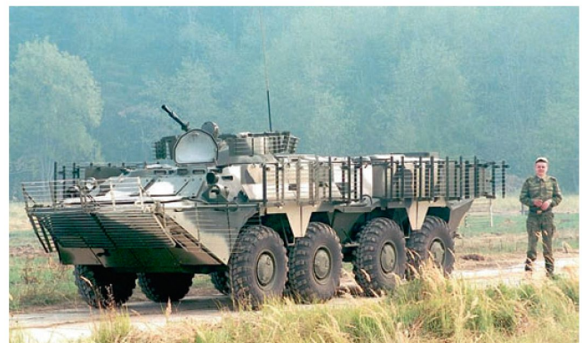
Schützenpanzer BTR-80 mit «Slat Armour».
