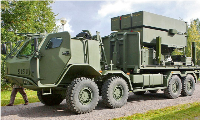
«NASAMS»-Startvorrichtung auf finnischem Lastwagen. Bild: MoD Finland
