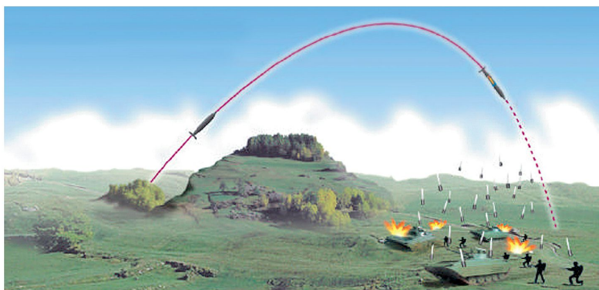
Funktionsprinzip 12 cm Mw Kanistergeschoss.
