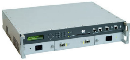
Modernes Verschlüsselungsgerät von Crypto AG: Das Ethernet Encryption HC-8555 10G verschlüsselt 10 Gigabit pro Sekunde. Quelle: Crypto AG
