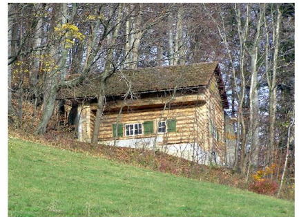
Ein als Chalet getarnter Bunker auf der Challhöchi.
