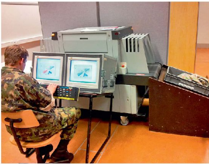
Abb. 3: Werksicherheit – Gepäckröntgenanlage bei der Vorkontrolle (VOKO).
