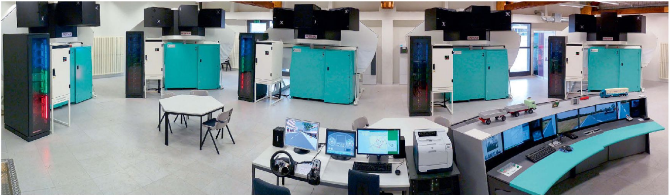
FATRAN WE bestehend aus fünf Trainingsstationen und einer Bedien- und Überwachungsstation, inklusive Übungsgenerierstation.
