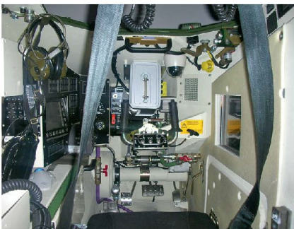
Teilansicht Fahrerkabine FASPA. Nachgebildeter Fahrerplatz des Spz 2000.
