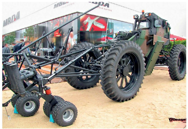
«Souvim 2» zur Aufklärung und Bekämpfung von improvisierten Sprengladungen und Minen. Bild: Autor
