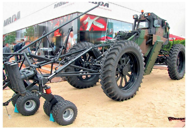
«Souvim 2» zur Aufklärung und Bekämpfung von improvisierten Sprengladungen und Minen. Bild: Autor
