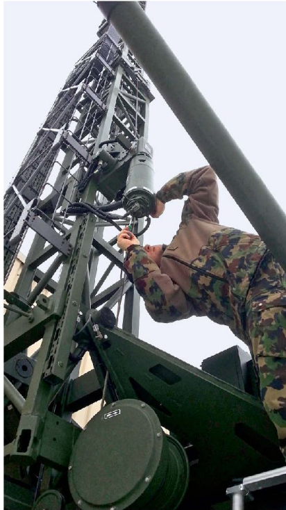
Der neue KOMPAK Pz: Der Notabbau des Mastens wird überprüft.
