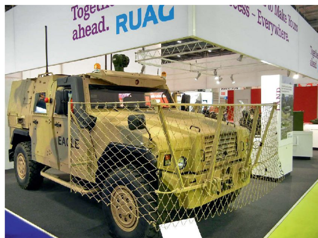
Kampffahrzeuge «Eagle» mit RPG-Schutz «SidePro-LASSO» von RUAG. Bilder: DSEI 2013
