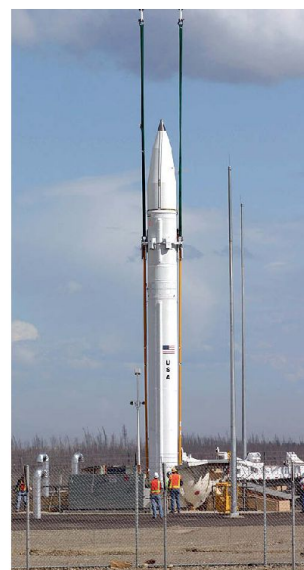
Eine GBI-Abfangrakete wird in einen Abschussilo geladen.
