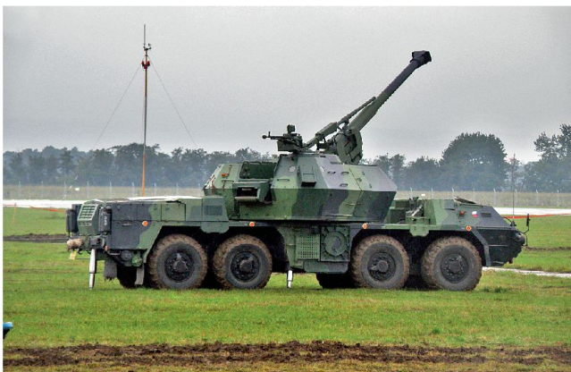
Selbstfahrgeschütz DANA-M1 auf Fahrgestell Tatra-815.
