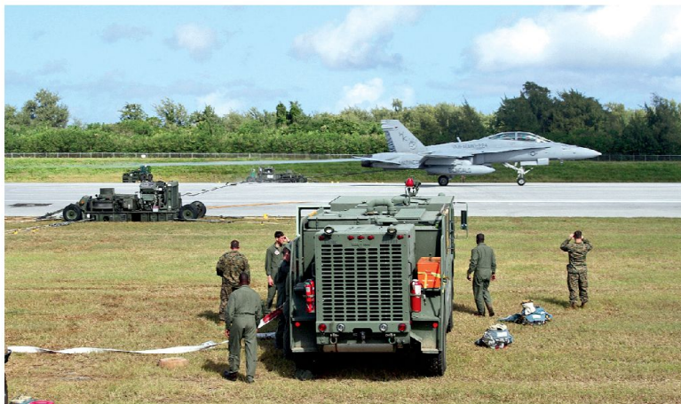
Eine F/A-18D Hornet der Marine All Weather Fighter Attack Squadron 224 landet mittels Fanghaken auf der nördlichen Marianen-Insel Tinian. 18 Bild: U.S. Marine Corps
