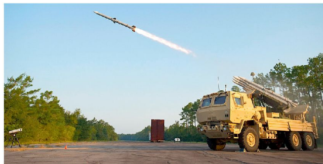
Beim System SL-AMRAAM werden Lenkwaffen AMRAAM für bodengestützte Luftverteidigung eingesetzt. Bild: Raytheon
