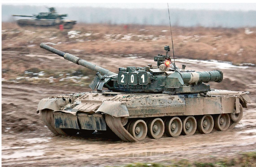
Kampfpanzer T-80U mit Gasturbine, 125 mm Kanone sowie Schnorchel hinten am Turm.
