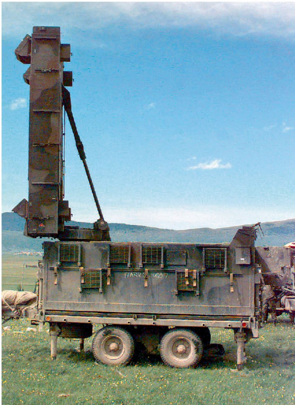
Lücke Artillerieradar (AN/TPQ-37, ThalesRaytheonSystems).
