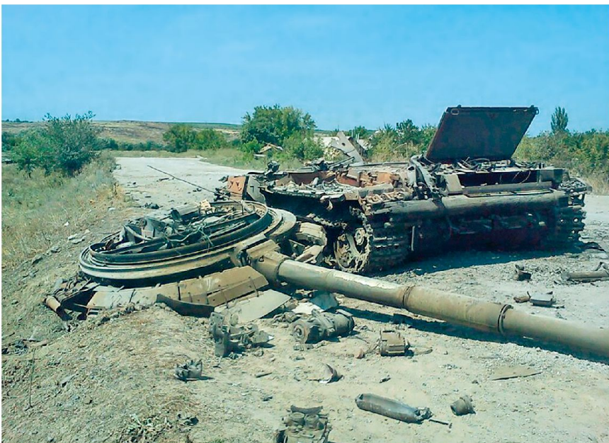
Zerstörter Kampfpanzer T-64BV, man beachte den durch die Explosion der Treibladungen weggeschleuderte Turm des Panzers.
