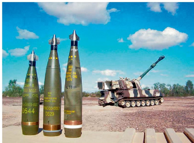
Das Precision Guidance Kit kann bei sämtlichen Artilleriegranaten 155 mm verwendet werden. Bild: US Army
