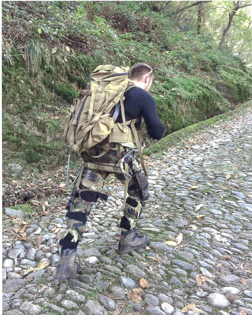
Testmarsch mit Exoskelett und Last.
