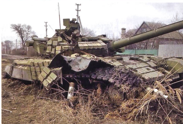
Zerstörter Kampfpanzer T-64BV, Schwachstelle Laufwerk.
