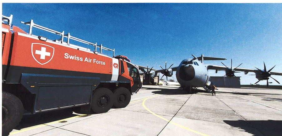
Alarmübung für das UP: Überhitzung am Hauptfahrwerk. Stellungsbezug TANGO, das heisst die Fahrzeuge stehen vor dem Flugzeug. Zur Brandvermeidung wird das Fahrwerk mit Ventilatoren gekühlt. Für den Notfall werden zwei Hohlstrahlrohre bereitgestellt. Bild: Maj Ruben Romero/VBS
