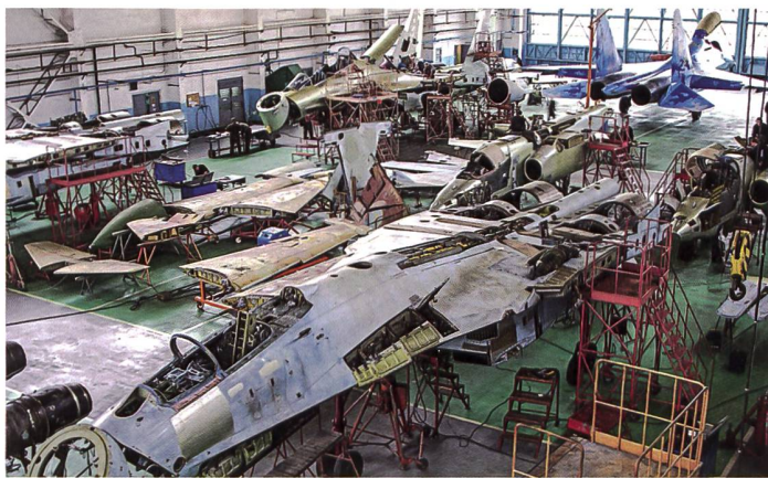
◀ Überholung von Su-27 und Su-25 der ukrainischen Luftwaffe. Die «jüngste» Su-27 hat Baujahr 1991. Über den Zustand der ukrainischen Luftwaffe gibt es widersprüchliche Angaben. Bild: via Twitter
